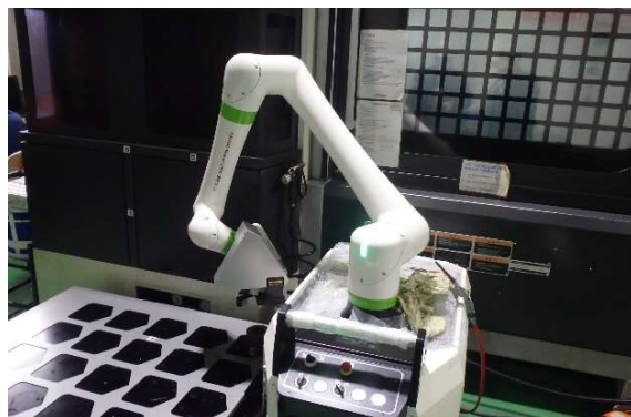
▽昨年度導入設備の一例：ロボット(ワーク着脱作業)
