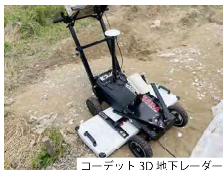
コーデット 3D 地下レーダー
