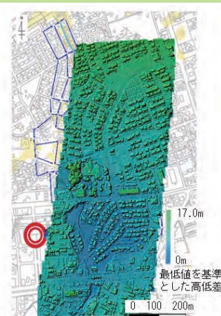
図5 ドローン航空測量の測量結果
