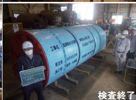
○どんな管を埋設しているの？→内径1500の円形管です。▼左写真は材料の搬入状況、右写真は特殊管の材料検査状況。
