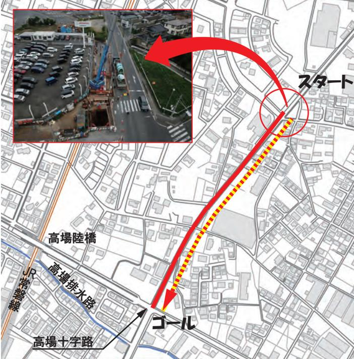
現在、高場十字路から北に高場雨水9号幹線管きょ布設工事を行っています（位置図参照）！この工事は、交通量の多い市道1級12号線に雨水管を埋設する工事です。市民の皆さまがよく目にする場所で、大変興味のある工事であると思います。今回は、そんな高場雨水9号幹線の工事を少し覗いてみましょう！
