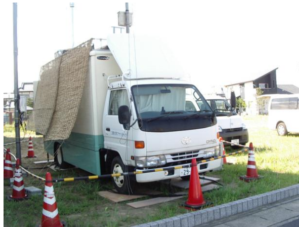
田中後交差点における自動車排出ガス環境濃度測定
